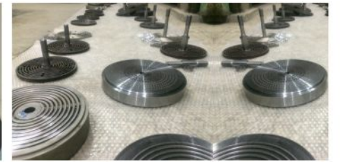
پروژه: ساخت ساکشن و دیسشارژ ولو تا سایز ۴۰۰ میلی متر کارفرما: پالایشگاه سازند اراک
