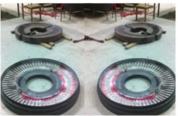
پروژه: ساخت دیافراگم توربین بخار کارفرما: پالایشگاه سازند اراک
