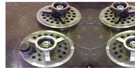
پروژه: ساخت ساکشن و دیسشارژ ولو کارفرما: فلات قاره
