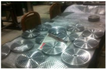
پروژه: ساخت ساکشن و دیسشارژ ولو کارفرما: مناطق نفت مرکزی (زاگرس جنوبی)
