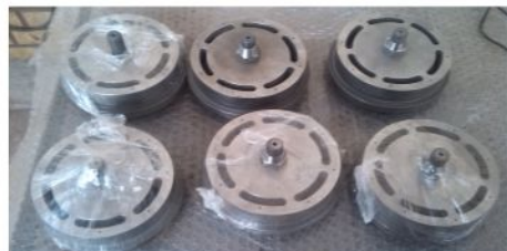
پروژه : ساخت DIS. VALVE کارفرما : پالایشگاه شیراز
