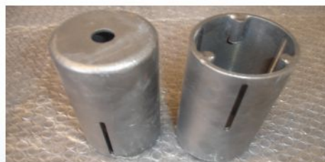
پروژه : ساخت BUBBLE CAP کارفرما : پالایشگاه شازند اراک
