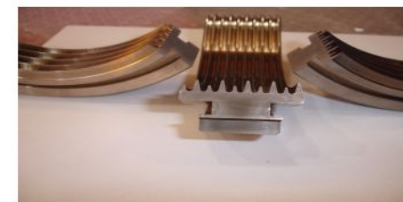
پروژه : ساخت LABYRINTH RING HP GLAND کارفرما : پالایشگاه شازند اراک
