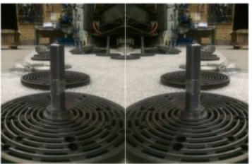
پروژه: ساخت ساکشن و دیسشارژ ولو متریال PEEK کارفرما: نفت و گاز گچساران
