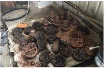
پروژه: تعمیر و احیاء ولوهای ساکشن و دیسشارژ کارفرما: پالایشگاه اربیل عراق
