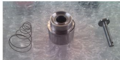
پروژه : ساخت IN TAKE VALVE کارفرما : پالایشگاه کرمانشاه
