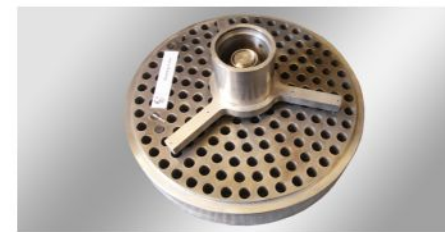
پروژه : ساخت SUC. VALVE C-1761 کارفرما : پالایشگاه شازند اراک
