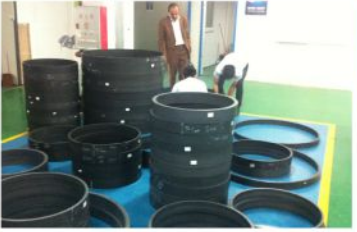
پروژه: ساخت رایدر رینگ و پیستون رینگ تا سایز ۱۱۰۰mm کارفرما: پالایشگاه سازند اراک
