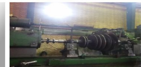
پروژه : اصلاح محل یاتاقان های ژورنال و تراست CT-3401 کارفرما : پالایشگاه شازند اراک
