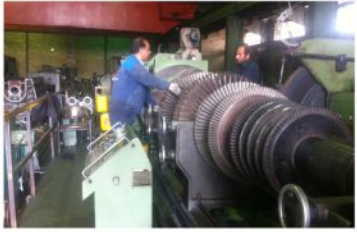
پروژه: اصلاح RUNOUT توربین ۲۰ مگاوات DRESSER کارفرما: پالایشگاه سازند اراک
